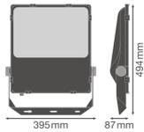
Scheda tecnica Ledvance Proiettore LED Performance 200W 26400lm 60D - 830 Luce Calda | IP66
