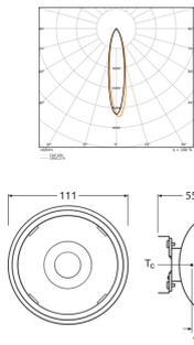
Scheda tecnica Ledvance Parathom Pro LEDspot G53 AR111 7.4W 450lm 24D - 930 Luce Calda | Miglior resa cromatica - Dimmerabile - Sostitutiva 50W
