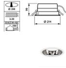
Scheda tecnica Philips Downlight LED LuxSpace Compacto Altezza ridotta DN570B 20.9W
